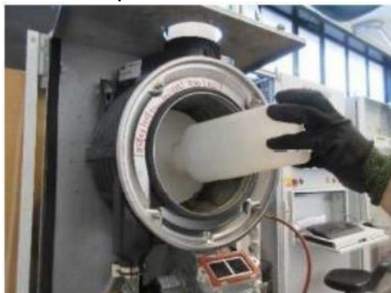
6. Spălați cu apă golurile din serpentinele schimbătorului de căldură.
